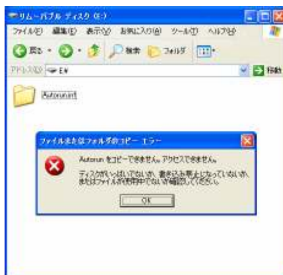
図 3. 「Autorun.inf」フォルダを含むリムーバブルドライブへ「Autorun.inf」ファイルのコピーを行った結果、エラーが発生しています。
