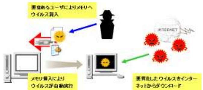
図1. クリーンな PC へ感染 USB が接続された例（悪意あるユーザによりウイルスが混入された USB フラッシュメモリを使用したことにより、攻撃が開始）
