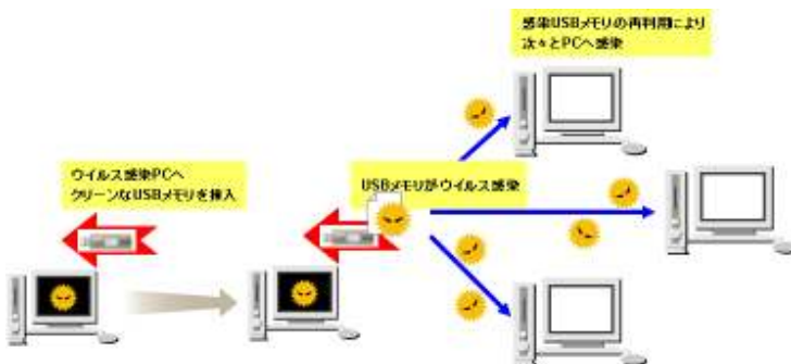
図2. USB フラッシュメモリを介した拡散活動例（ウイルス感染した PC へクリーンな USB フラッシュメモリが挿入され、汚染。感染 USB フラッシュメモリの再利用によりウイルスが拡散）
